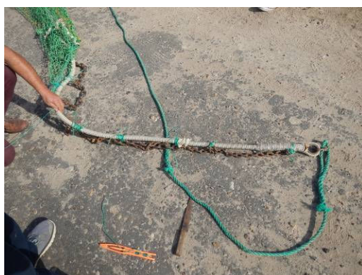
Figura 7. Relinga de plomos o inferior confeccionada de cabo combinado de 16mm en cuya extensión y de forma equidistante se colocaron 7 pequeñas secciones de cadena (aproximadamente 60cm de largo) a fin de lograr un contacto efectivo con el fondo.
